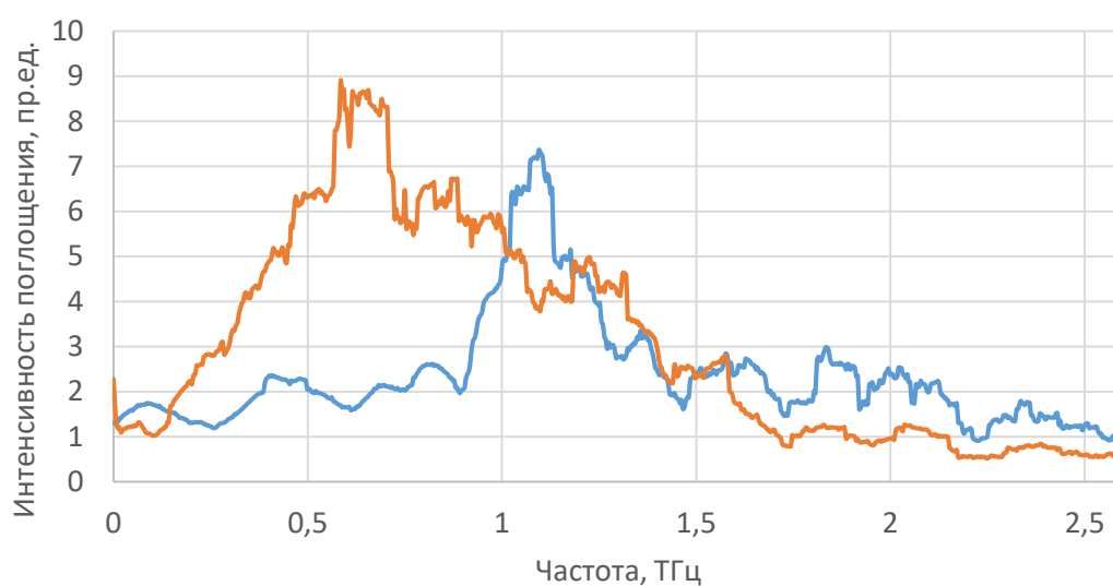
Рис. 5. Спектр поглощения дымного и бездымного пороха
