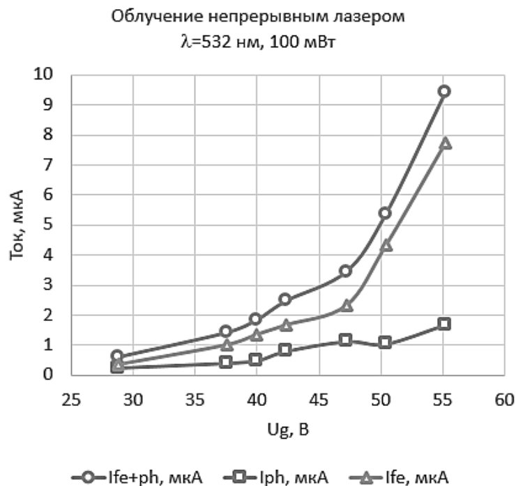
Рис. 3. Вольт-амперные характеристики вакуумного микродиода при облучении непрерывным лазерным излучением с длиной волны 532 нм и выходной мощностью 100 мВт
